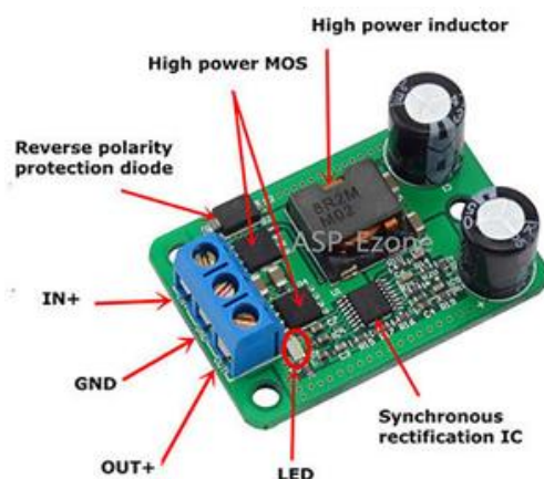
Slika 70 – Bak konverter za napon od 5VDC.
