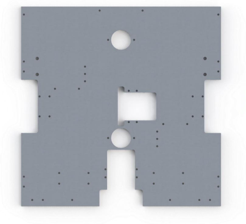
Slika 8 – Noseća ploča robota: levo i desno su prorezi za pogonske točkove, u sredini ploče je prvi pasivni odometrijski točak, na zadnjoj strani prorez za drugi pasivni odometrijski točak, u kružnim rupama se nalaze točkovi za stabilizaciju robota.
